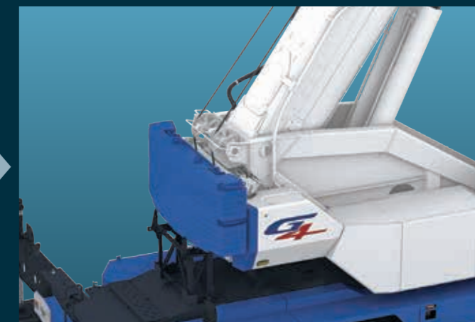
カウンタウエイトを油圧シリンダで引き上げ、旋回体後端に取付。
