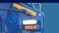
ブーム先端に被視認性を高める高輝度のLEDライトを装備しています。
