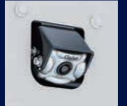
車体の前後左右にカメラを搭載し、4方向の映像を合成。
